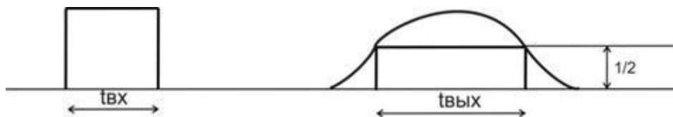
2.19 Сурет- Талшық бойымен таралатын импульстің өткізу жолағы
